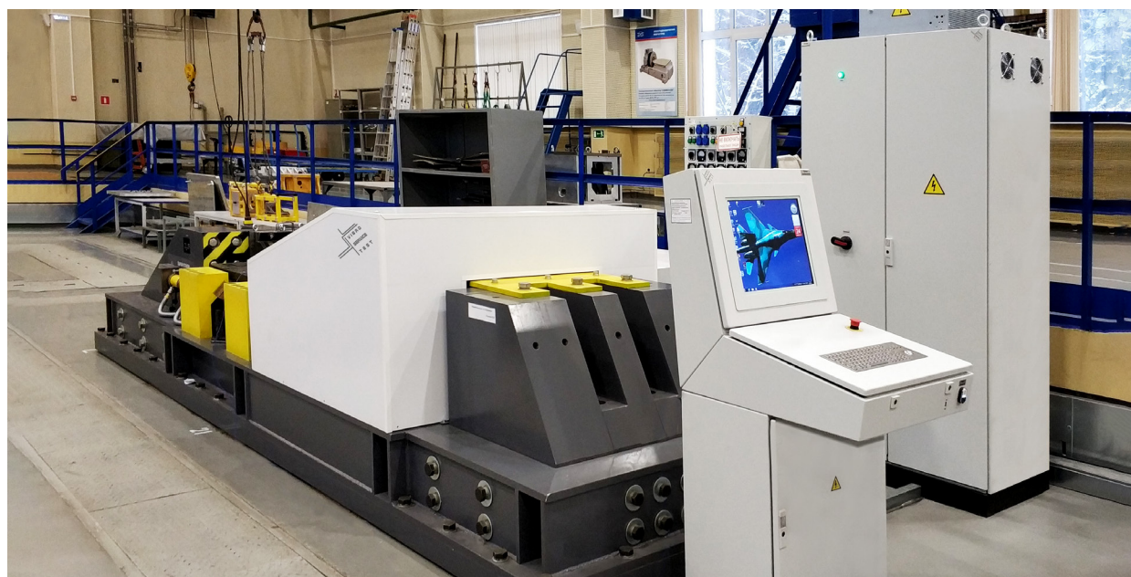
Горизонтальная Ударная установка ГУС ВСТС-450/300 с силовым шкафом и пультом управления
