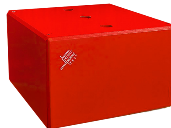
Аттестационный груз (эквивалент нагрузки) массой 750 кг
