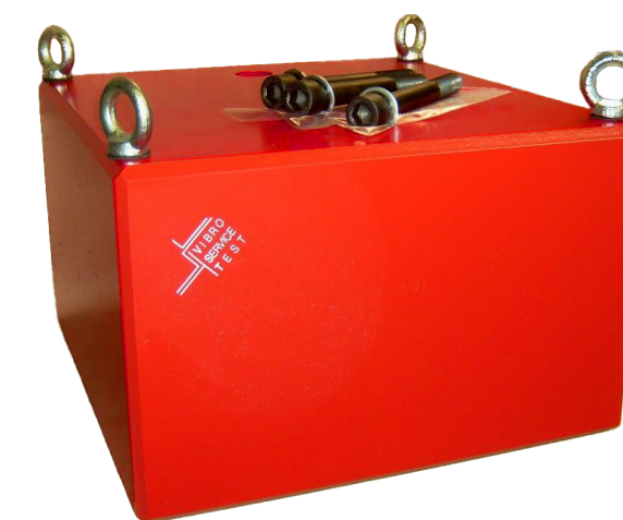
Аттестационный груз (эквивалент нагрузки) массой 1000 кг
