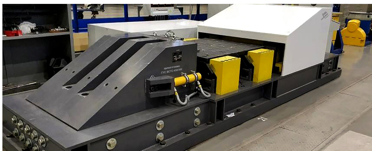
Горизонтальная Ударная установка ГУС ВСТС-450/300
