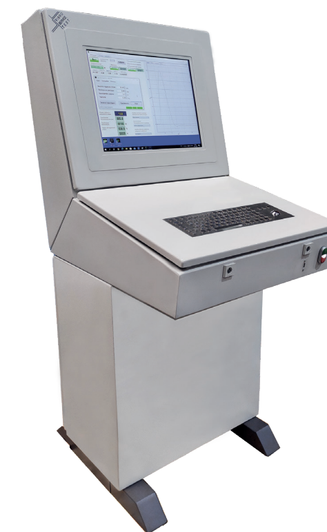
Пульт управления Ударной установки ВСТС - 1000/1000
