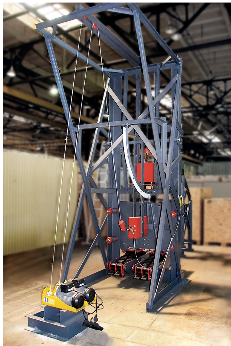
Ударная установка типа Копёр К-200
