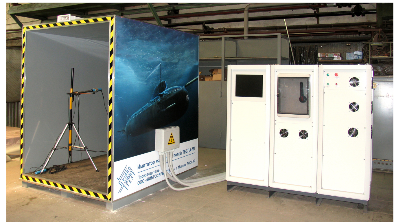
Имитатор магнитных полей МС-1 (Тесла-МТ)
